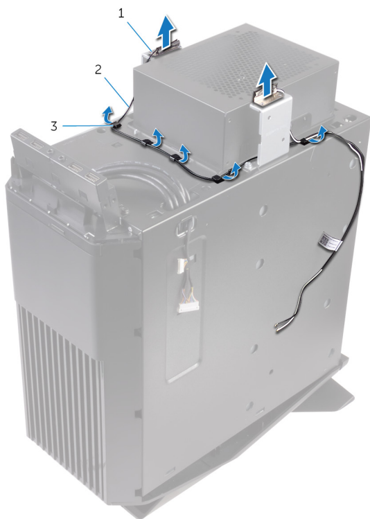
Obrázek 36. Demontáž anténních kabelů
